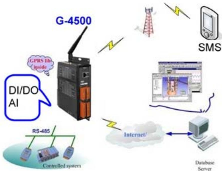
Aplicación 1: Sistema de monitoreo y control remoto
