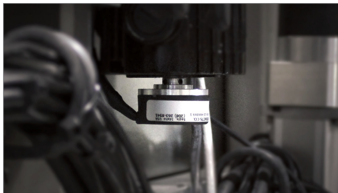
Encoder Incremental Modelo 15 en uso en una etiquetadora en línea
