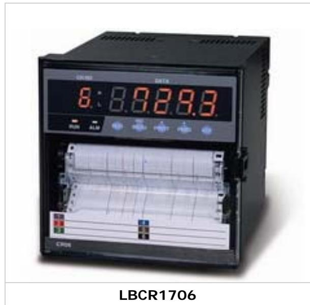
Registrador de gráficas con impresión a papel estilo matriz de puntos de 6 entradas universales (V, mA, Temperatura), bajo costo, poca profundidad (150mm), peso reducido 1.5 Kg. y resistencia al agua con protección IP-65.
