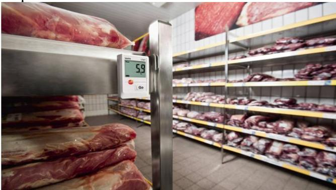
Figura 2. Datalogger – sensor de temperatura alimenticio
