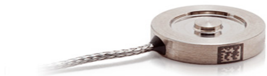
Figura 10. Celda de carga tipo botón LLB250
