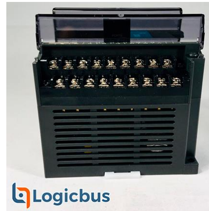
Fig. 1. Fotografía de un PLC, número de parte FBS-20MCR2-AC .
