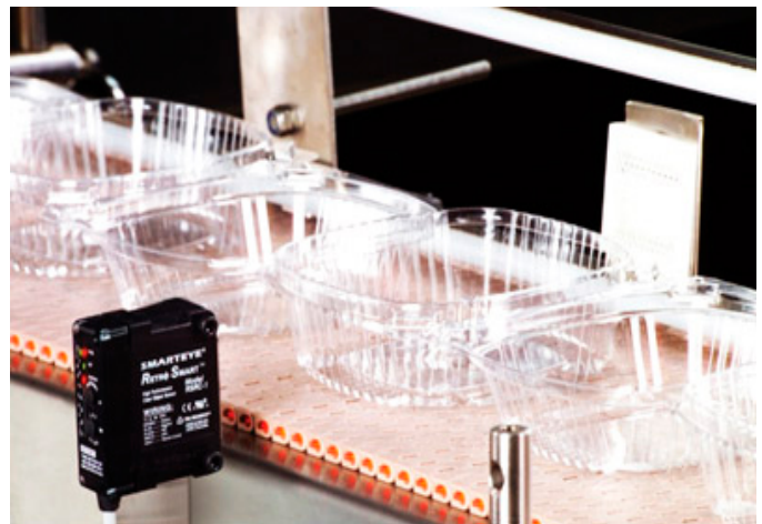
Figura 1. Sensor fotoeléctrico que detecta la presencia de un objeto por medio de un haz de luz
