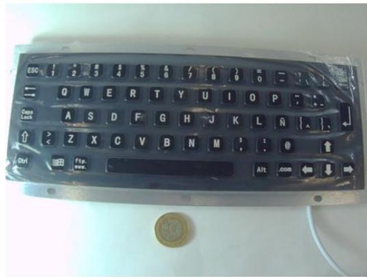
Teclado industrial en español con 64 teclas, terminado en acero inoxidable en color negro, interfaz USB, protección NEMA4X IP65 resistente al agua, polvo y vandalismo. Dimensiones 300mm x 110mm. Incluye USB Host para conectar un accesorio y cable de 5m.
