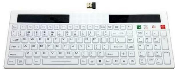
Teclado solar inalámbrico 2.4G. Material silicon rigido blanco. Trabaja en cuartos con luz ambiente. Comunicación: receptor USB2.0. 105 Teclas Dimensiones: 380x150x14mm. Nivel de protección: IP65
