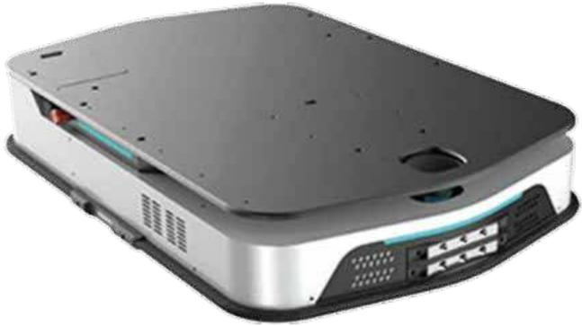
Cuerpo principal; Tamaño: 1042x703x200mm, diámetro de rotación: 1092mm, peso: 120Kg. Navegación por Laser. Carga máxima: 300Kg. Velocidad máxima: 1.5m/s. Batería: 51.2V @ 30Ah, tiempo de funcionamiento: 10H, tiempo de carga: <=2H. Red inalámbrica: IEEE 802.11 A/C
