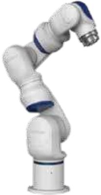
El Cobot SCR5 es el primer robot antropomórfico de 7 grados de libertad con configuración rápida, enseñanza de tracción, guía visual y detección de colisiones.
